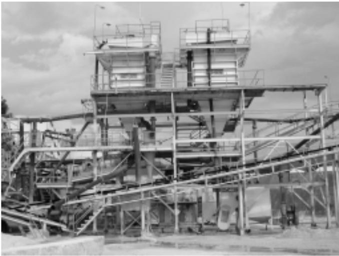
Figura 4. Planta de lavado de arena sílica. La arenisca de cuarzo extraída de la mina es alimentada a la planta donde se separan los granos de arena gruesa mayores que 600 micrones y los granos de arena fina menores que 100 micrones por medio de equipos de clasificación con agua.
