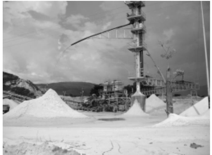
Figura 5. Patio de escurrimiento. Torre de producto terminado de arena sílica para envases de vidrio, vidrio plano y cristalería. Al fondo se observa la planta de lavado. Después de al menos 72 horas de escurrimiento el producto húmedo se alimenta a un horno rotatorio para su secado y almacenamiento y posteriormente ser embarcado al mercado.
