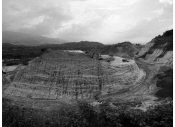
*Figura 3. Mina de arenisca de cuarzo en preparación para extracción y acarreo de materia prima a planta de lavado. Se observa equipo de extracción y acarreo realizando la operación de remoción de cuerpo de arcilla superior (mineral estéril).*
